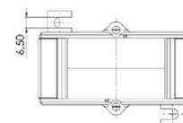
Sekundärseitig umschaltbare Aufsteck-Stromwandler für Primär-Nennströme von 500-250 A bis zu 1200-600 A mit einem Sekundär-Nennstrom von 5 A oder 1 A (optional 2 A), in der Genauigkeitsklasse 1.
