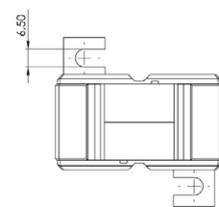
Rohrstab-Stromwandler für Primär-Nennströme von 50 A bis 600 A mit einem Sekundär-Nennstrom von 5 A oder 1 A (optional 2 A), in den Genauigkeitsklassen 0,2s, 0,5 und 1 (optional in Klasse 0,2 und 0,5s).
