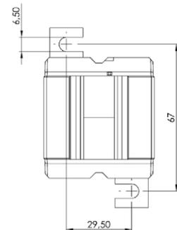
Rohrstab-Stromwandler für Primär-Nennströme von 50 A bis 600 A mit einem Sekundär-Nennstrom von 5 A oder 1 A (optional 2 A), in den Genauigkeitsklassen 0,5 und 1.
