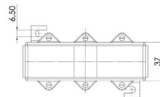
Dreiphasen-Stromwandlersatz für Primär-Nennströme von 3 x 100 A bis 3 x 250 A mit einem Sekundär-Nennstrom von 5 A oder 1 A, in der Genauigkeitsklasse 1.
