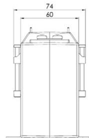
Schutz-Aufsteck-Stromwandler für Primär-Nennströme von 50 A bis 750 A mit einem Sekundär-Nennstrom von 5 A oder 1 A (optional 2 A), in den Schutzklassen 5P5, 10P5, 5P10 und 10P10.
