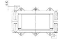
Aufsteck-Stromwandler für Primär-Nennströme von 2500 A bis 4000 A mit einem Sekundär-Nennstrom von 5 A oder 1 A (optional 2 A), in den Genauigkeitsklassen 0,5 und 1.
