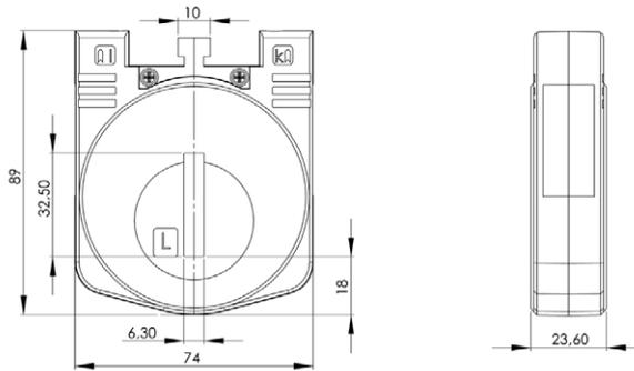
Stromwandler für Sicherungstrennleisten für Primär-Nennströme von 150 A bis 600 A mit einem Sekundär-Nennstrom von 5 A oder 1 A, in der Genauigkeitsklasse 3.
