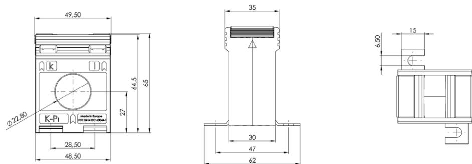
Rohrstab-Stromwandler für Primär-Nennströme von 100 A bis 500 A mit einem Sekundär-Nennstrom von 5 A oder 1 A (optional 2 A), in der Genauigkeitsklasse 1.
