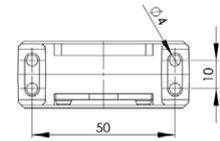
Zweifach sekundärseitig umschaltbarer Stromwandler für Sicherungstrennleisten für Primär-Nennströme von 200-100 A bis 400-200 A mit einem Sekundär-Nennstrom von 5 A oder 1 A, in der Genauigkeitsklasse 3.
