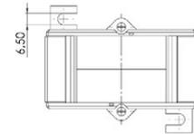
Aufsteck-Stromwandler für Primär-Nennströme von 100 A bis 1250 A mit einem Sekundär-Nennstrom von 5 A oder 1 A (optional 2 A), in den Genauigkeitsklassen 0,2s, 0,5 und 1 (optional in Klasse 0,2 und 0,5s).
