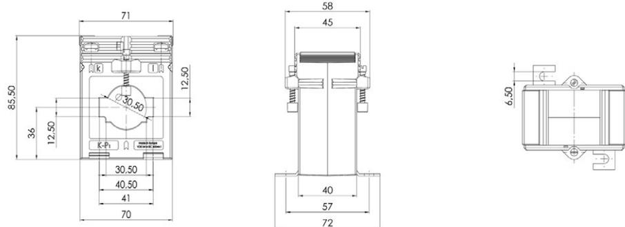
Sekundärseitig umschaltbare Aufsteck-Stromwandler für Primär-Nennströme von 200-100 A bis zu 800-400 A mit einem Sekundär-Nennstrom von 5 A oder 1 A (optional 2 A), in der Genauigkeitsklasse 1.
