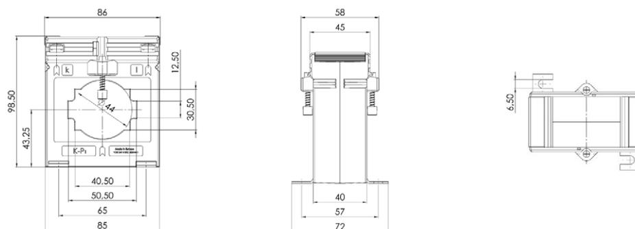
Schutz-Aufsteck-Stromwandler für Primär-Nennströme von 150 A bis 1000 A mit einem Sekundär-Nennstrom von 5 A oder 1 A (optional 2 A), in den Schutzklassen 5P5 und 10P5.
