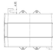
Schutz-Aufsteck-Stromwandler für Primär-Nennströme von 250 A bis 1500 A mit einem Sekundär-Nennstrom von 5 A oder 1 A (optional 2 A), in den Schutzklassen 5P5, 10P5, 5P10 und 10P10.
