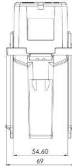
Kompakter Stromwandler mit teilbarem Messkern, zur Aufnahme von 2 x 42 mm Rundleitern
