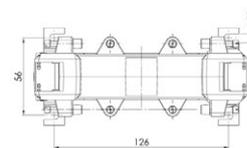
Stromwandler mit teilbarem Messkern für Primär-Nennströme von 250 A bis 1500 A mit einem Sekundär-Nennstrom von 5 A oder 1 A (optional 2 A), in den Genauigkeitsklassen 0,5 und 1.
