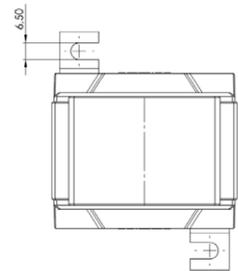
Wickel-Stromwandler für Primär-Nennströme von 5 A bis 30 A mit einem Sekundär-Nennstrom von 5 A oder 1 A (optional 2 A), in den Genauigkeitsklassen 0,5 und 1.
