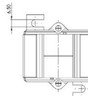
Sekundärseitig umschaltbare Aufsteck-Stromwandler für Primär-Nennströme von 200-100 A bis zu 600-300 A mit einem Sekundär-Nennstrom von 5 A oder 1 A (optional 2 A), in der Genauigkeitsklasse 1.
