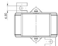
Schutz-Aufsteck-Stromwandler für Primär-Nennströme von 125 A bis 200 A mit einem Sekundär-Nennstrom von 5 A oder 1 A (optional 2 A), in den Schutzklassen 5P5 und 10P5.
