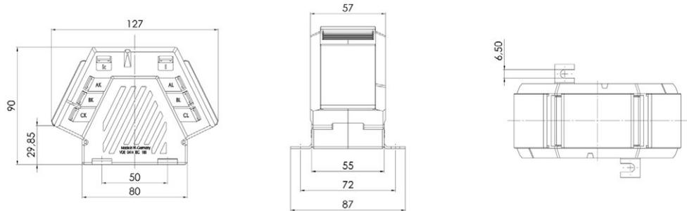
Summen-Stromwandler für Primär-Nennströme mit 5 A oder 1 A und einem Sekundär-Nennstrom von 5 A oder 1 A (optional 2 A) für den Anschluss von 2 Hauptwandlern, in den Genauigkeitsklassen 0,5 und 1.
