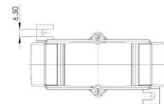
Aufsteck-Stromwandler für Primär-Nennströme von 400 A bis 2000 A mit einem Sekundär-Nennstrom von 5 A oder 1 A (optional 2 A), in den Genauigkeitsklassen 0,2s, 0,5 und 1 (optional in Klasse 0,2 und 0,5s).
