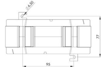
Summen-Stromwandler für Primär-Nennströme mit 5 A oder 1 A und einem Sekundär-Nennstrom von 5 A oder 1 A (optional 2 A) für den Anschluss von 5 Hauptwandlern, in den Genauigkeitsklassen 0,5 und 1 (optional in Klasse 0,2).
