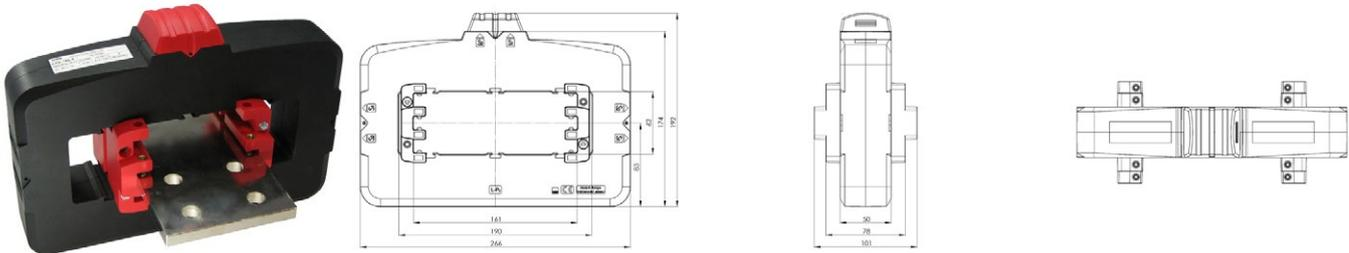
Aufsteck-Stromwandler mit teilvergossenem Messsystem und einem neu entwickelten variablen Befestigungssystem für Primär-Nennströme von 1000 A bis 4000 A mit einem Sekundär-Nennstrom von 5 A oder 1 A (optional 2 A), in den Genauigkeitsklassen 0,2, 0,5 und 1. (Schutz-Klassen auf Anfrage) Zeitsparende Kontaktierung dank definierbarer Position der Sekundäranschlussklemmen (Bitte bei Bestellung angeben). Die Spannpratzen (Art-Nr. 59090) für den Primärleiter sind optional erhältlich.
