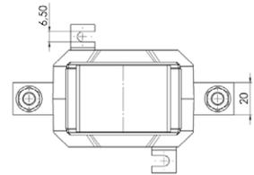
Wickel-Stromwandler für Primär-Nennströme von 25 A bis 100 A mit einem Sekundär-Nennstrom von 5 A oder 1 A (optional 2 A), in den Genauigkeitsklassen 0,5 und 1.
