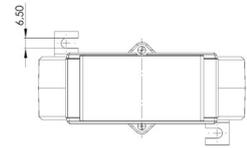
Aufsteck-Stromwandler für Primär-Nennströme von 500 A bis 2000 A mit einem Sekundär-Nennstrom von 5 A oder 1 A (optional 2 A), in den Genauigkeitsklassen 0,5 und 1.
