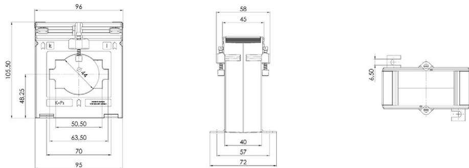
Schutz-Aufsteck-Stromwandler für Primär-Nennströme von 200 A bis 1250 A mit einem Sekundär-Nennstrom von 5 A oder 1 A (optional 2 A), in den Schutzklassen 5P5 und 10P5.
