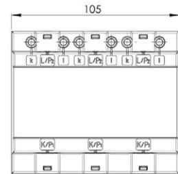
Dreiphasen-Stromwandlersatz für Primär-Nennströme von 3 x 50 A bis 3 x 150 A mit einem Sekundär-Nennstrom von 5 A oder 1 A, in den Genauigkeitsklassen 0,5 und 1.
