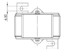
Aufsteck-Stromwandler für Primär-Nennströme von 100 A bis 750 A mit einem Sekundär-Nennstrom von 5 A oder 1 A (optional 2 A), in der Genauigkeitsklasse 1.
