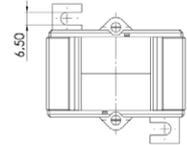
Aufsteck-Stromwandler für Primär-Nennströme von 50 A bis 1000 A mit einem Sekundär-Nennstrom von 5 A oder 1 A (optional 2 A), in den Genauigkeitsklassen 0,2s, 0,5 und 1 (optional in Klasse 0,2 und 0,5s).
