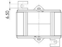
Schutz-Aufsteck-Stromwandler für Primär-Nennströme von 100 A bis 400 A mit einem Sekundär-Nennstrom von 5 A oder 1 A (optional 2 A), in den Schutzklassen 5P5 und 10P5.
