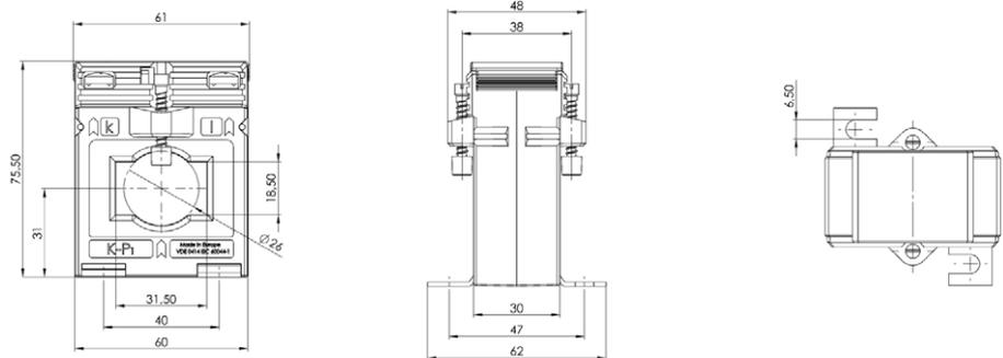
Aufsteck-Stromwandler für Primär-Nennströme von 60 A bis 600 A mit einem Sekundär-Nennstrom von 5 A oder 1 A (optional 2 A), in den Genauigkeitsklassen 0,5 und 1.
