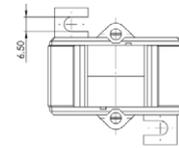
Sekundärseitig umschaltbare Aufsteck-Stromwandler für Primär-Nennströme von 200-100 A bis zu 600-300 A mit einem Sekundär-Nennstrom von 5 A oder 1 A (optional 2 A), in der Genauigkeitsklasse 1.
