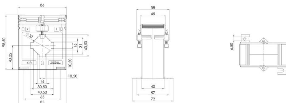
Schutz-Aufsteck-Stromwandler für Primär-Nennströme von 100 A bis 1000 A mit einem Sekundär-Nennstrom von 5 A oder 1 A (optional 2 A), in den Schutzklassen 5P5, 10P5, 5P10 und 10P10.
