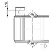
Sekundärseitig umschaltbare Aufsteck-Stromwandler für Primär-Nennströme von 300-200-100 A bis zu 600-400-200 A mit einem Sekundär-Nennstrom von 5 A oder 1 A (optional 2 A), in der Genauigkeitsklasse 1.
