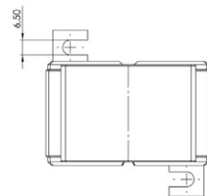
Wickel-Stromwandler für Primär-Nennströme von 1 A bis 30 A mit einem Sekundär-Nennstrom von 5 A oder 1 A (optional 2 A), in den Genauigkeitsklassen 0,5 und 1.
