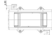
Schutz-Aufsteck-Stromwandler für Primär-Nennströme von 600 A bis 1600 A mit einem Sekundär-Nennstrom von 5 A oder 1 A (optional 2 A), in den Schutzklassen 5P5 und 10P5.
