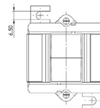
Sekundärseitig umschaltbare Aufsteck-Stromwandler für Primär-Nennströme von 150-75 A bis zu 600-300 A mit einem Sekundär-Nennstrom von 5 A oder 1 A (optional 2 A), in der Genauigkeitsklasse 1 (optional in Klasse 0,5s und 0,5).
