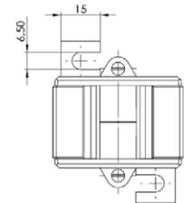
Aufsteck-Stromwandler für Primär-Nennströme von 60 A bis 400 A mit einem Sekundär-Nennstrom von 5 A oder 1 A (optional 2 A), in der Genauigkeitsklasse 1.
