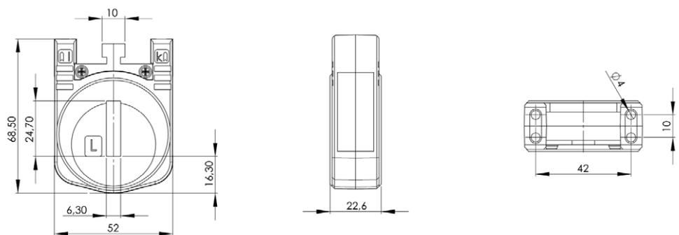
Zweifach sekundärseitig umschaltbarer Stromwandler für Sicherungstrennleisten für Primär-Nennströme von 200-100 A bis 300-150 A mit einem Sekundär-Nennstrom von 5 A oder 1 A, in der Genauigkeitsklasse 3.
