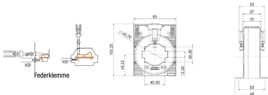
Aufsteck-Stromwandler für Primär-Nennströme von 100 A bis 1250 A mit einem Sekundär-Nennstrom von 5 A oder 1 A, in den Genauigkeitsklassen 1 und 3. Weltweit erster Stromwandler mit schraubenloser Anschlusstechnik – Federzugklemme „Cage Clamp®“. Die Stromwandler der Typenreihe CTB sind UL zertifiziert.
