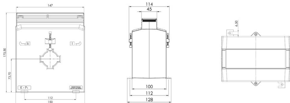
Schutz-Aufsteck-Stromwandler für Primär-Nennströme von 75 A bis 800 A mit einem Sekundär-Nennstrom von 5 A oder 1 A (optional 2 A), in den Schutzklassen 5P5, 10P5, 5P10 und 10P10.
