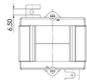
Aufsteck-Stromwandler für Primär-Nennströme von 60 A bis 1000 A mit einem Sekundär-Nennstrom von 5 A oder 1 A (optional 2 A), in den Genauigkeitsklassen 0,5 und 1 (optional in Klasse 0,2 und 0,5s).
