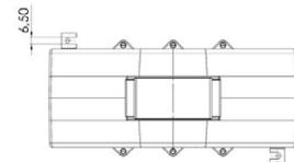
Aufsteck-Stromwandler für Primär-Nennströme von 1000 A bis 7500 A mit einem Sekundär-Nennstrom von 5 A oder 1 A (optional 2 A), in den Genauigkeitsklassen 0,5 und 1.
