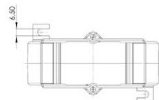
Sekundärseitig umschaltbare Aufsteck-Stromwandler für Primär-Nennströme von 1000-750-500 A bis zu 1600-1000-750 A mit einem Sekundär-Nennstrom von 5 A oder 1 A (optional 2 A), in der Genauigkeitsklasse 1.
