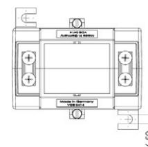
Aufsteck-Stromwandler für Primär-Nennströme von 100 A bis 1250 A mit einem Sekundär-Nennstrom von 5 A oder 1 A (optional 2 A), in den Genauigkeitsklassen 0,5 und 1 (optional in Klasse 0,2 und 0,5s).
