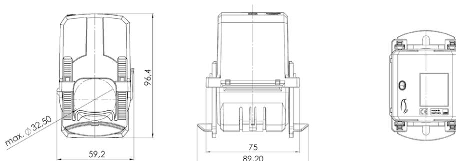
Kompakter Stromwandler mit teilbarem Messkern für Primär-Nennströme von 100 bis 600 A mit einem Sekundär-Nennstrom von 1 A oder 5 A. Optional erhältlich mit 4...20 mA DC-Strom- oder 0...333 mV Spannungsausgang für den Einsatz als Stromsensor. Anschlussleitungslänge: 2,5 m 2x0,75 mm<sup>2</sup> bei Sekundär 1A, 0,5 m 2x1,5 mm<sup>2</sup> bei Sekundär 5A
