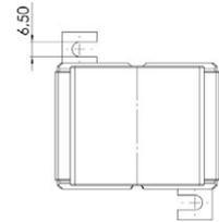
Wickel-Stromwandler für Primär-Nennströme von 30 A bis 50 A mit einem Sekundär-Nennstrom von 5 A oder 1 A (optional 2 A), in den Genauigkeitsklassen 0,5 und 1.
