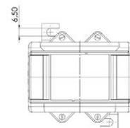
Aufsteck-Stromwandler für Primär-Nennströme von 200 A bis 1600 A mit einem Sekundär-Nennstrom von 5 A oder 1 A (optional 2 A), in den Genauigkeitsklassen 0,5 und 1 (optional in Klasse 0,2 und 0,5s).
