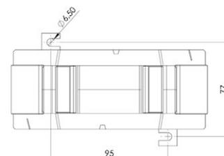
Summen-Stromwandler für Primär-Nennströme mit 5 A oder 1 A und einem Sekundär-Nennstrom von 5 A oder 1 A (optional 2 A) für den Anschluss von 7 Hauptwandlern, in den Genauigkeitsklassen 0,5 und 1 (optional in Klasse 0,2).
