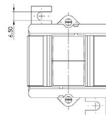
Aufsteck-Stromwandler für Primär-Nennströme von 40 A bis 750 A mit einem Sekundär-Nennstrom von 5 A oder 1 A (optional 2 A), in den Genauigkeitsklassen 0,5 und 1 (optional in Klasse 0,2s, 0,2 und 0,5s).
