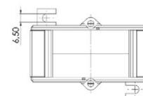
Sekundärseitig umschaltbare Aufsteck-Stromwandler für Primär-Nennströme von 800-400-200 A bis zu 1200-600-300 A mit einem Sekundär-Nennstrom von 5 A oder 1 A (optional 2 A), in der Genauigkeitsklasse 1.
