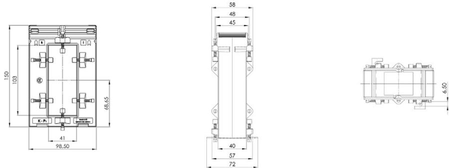
Aufsteck-Stromwandler für Primär-Nennströme von 400 A bis 2000 A mit einem Sekundär-Nennstrom von 5 A oder 1 A (optional 2 A), in den Genauigkeitsklassen 0,5 und 1.
