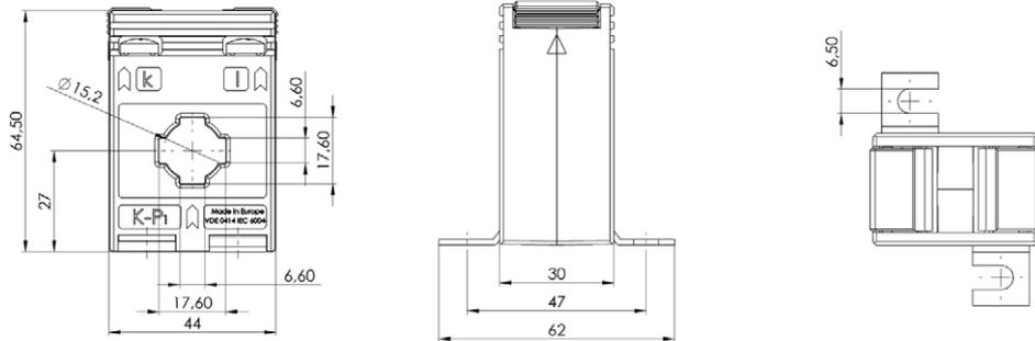
Aufsteck-Stromwandler passend für SlimLine XR Größe XR1 für Primär-Nennströme von 75 A bis 250 A mit einem Sekundär-Nennstrom von 5 A oder 1 A (optional 2 A), in den Genauigkeitsklassen 3, 1 und 0,5. Zur Installation des Wandlers innerhalb der genannten Leiste ist die Verwendung eines speziellen - im Liefersortiment der Fa. ABB enthaltenen- Stromschienenadapters erforderlich.
