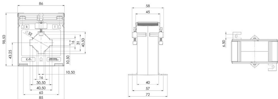
Aufsteck-Stromwandler für Primär-Nennströme von 30 A bis 1000 A mit einem Sekundär-Nennstrom von 5 A oder 1 A (optional 2 A), in den Genauigkeitsklassen 0,2s, 0,5 und 1 (optional in Klasse 0,2 und 0,5s).
