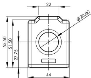
Rohrstab-Stromwandler mit Polyurethanharz vergossenem Messsystem für Primär-Nennströme von 60 A bis 300 A mit einem Sekundär-Nennstrom von 5 A oder 1 A (optional 2 A), in der Genauigkeitsklasse 1 mit flexiblen 2,5 mm<sup>2</sup> Cu-Litzeleitungen (Sekundäranschlussleitungen).
