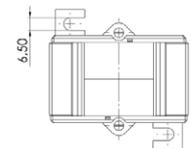
Schutz-Aufsteck-Stromwandler für Primär-Nennströme von 100 A bis 750 A mit einem Sekundär-Nennstrom von 5 A oder 1 A (optional 2 A), in den Schutzklassen 5P5 und 10P5.
