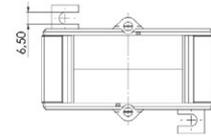
Aufsteck-Stromwandler für Primär-Nennströme von 200 A bis 1600 A mit einem Sekundär-Nennstrom von 5 A oder 1 A (optional 2 A), in den Genauigkeitsklassen 0,2s, 0,5 und 1 (optional in Klasse 0,2 und 0,5s).
