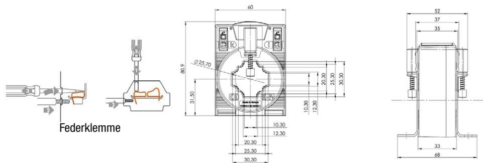
Aufsteck-Stromwandler für Primär-Nennströme von 50 A bis 750 A mit einem Sekundär-Nennstrom von 5 A oder 1 A, in den Genauigkeitsklassen 1 und 3. Weltweit erster Stromwandler mit schraubenloser Anschlusstechnik – Federzugklemme „Cage Clamp®“. Die Stromwandler der Typenreihe CTB sind UL zertifiziert.
