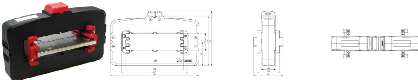
Aufsteck-Stromwandler mit teilvergossenem Messsystem und einem neu entwickelten variablen Befestigungssystem für Primär-Nennströme von 1200 A bis 5000 A mit einem Sekundär-Nennstrom von 5 A oder 1 A (optional 2 A), in den Genauigkeitsklassen 0,2, 0,5 und 1. (Schutz-Klassen auf Anfrage) Zeitsparende Kontaktierung dank 3 definierbarer Positionen der Sekundäranschlussklemmen (Bitte bei Bestellung angeben). Die Spannpratzen (Art-Nr. 59090) für den Primärleiter sind optional erhältlich.
