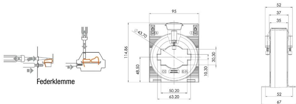
Aufsteck-Stromwandler für Primär-Nennströme von 200 A bis 1600 A mit einem Sekundär-Nennstrom von 5 A oder 1 A, in den Genauigkeitsklassen 1 und 3. Weltweit erster Stromwandler mit schraubenloser Anschlusstechnik – Federzugklemme „Cage Clamp®“. Die Stromwandler der Typenreihe CTB sind UL zertifiziert.
