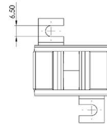
Rohrstab-Stromwandler für Primär-Nennströme von 50 A bis 300 A mit einem Sekundär-Nennstrom von 5 A oder 1 A (optional 2 A), in den Genauigkeitsklassen 3, 1 und 0,5.
