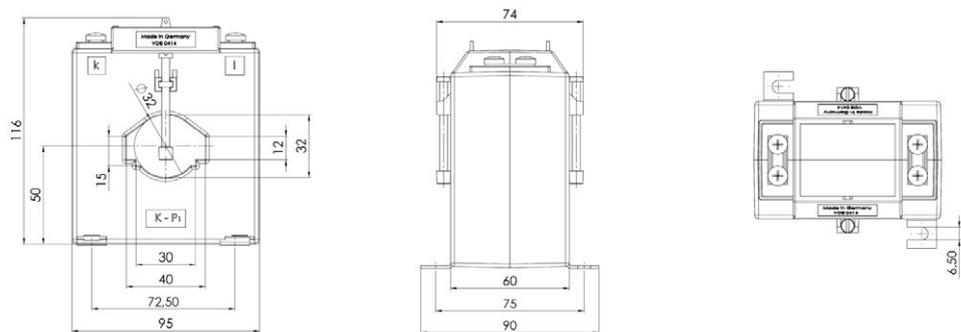
Aufsteck-Stromwandler für Primär-Nennströme von 50 A bis 1000 A mit einem Sekundär-Nennstrom von 5 A oder 1 A (optional 2 A), in den Genauigkeitsklassen 0,5 und 1 (optional in Klasse 0,2 und 0,5s).
