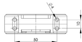
Zweifach sekundärseitig umschaltbarer Stromwandler für Sicherungstrennleisten für Primär-Nennströme von 300-150 A bis 600-300 A mit einem Sekundär-Nennstrom von 5 A oder 1 A, in der Genauigkeitsklasse 3.
