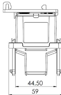
Kompakter Stromwandler mit teilbarem Messkern. Schnappbefestigung für Hutschiene optional
