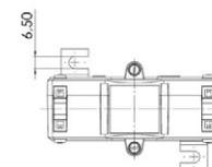
Schutz-Aufsteck-Stromwandler für Primär-Nennströme von 200 A bis 1000 A mit einem Sekundär-Nennstrom von 5 A oder 1 A (optional 2 A), in den Schutzklassen 5P5 und 10P5.
