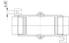
Sekundärseitig umschaltbare Aufsteck-Stromwandler für Primär-Nennströme von 1000-500 A bis zu 1600-800 A mit einem Sekundär-Nennstrom von 5 A oder 1 A (optional 2 A), in der Genauigkeitsklasse 1.
