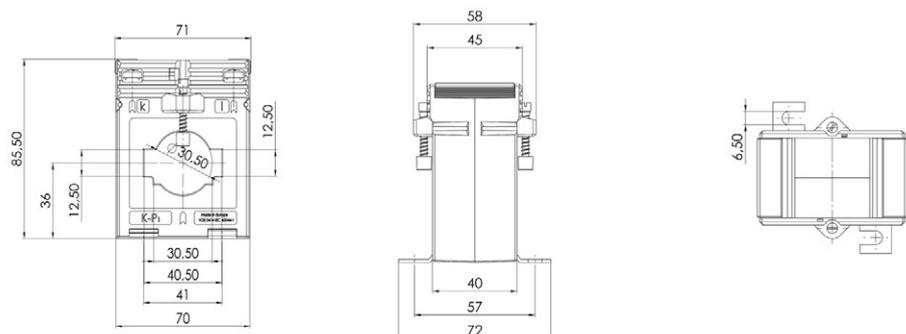
Sekundärseitig umschaltbare Aufsteck-Stromwandler für Primär-Nennströme von 400-200-100 A bis zu 800-400-200 A mit einem Sekundär-Nennstrom von 5 A oder 1 A (optional 2 A), in der Genauigkeitsklasse 1.
