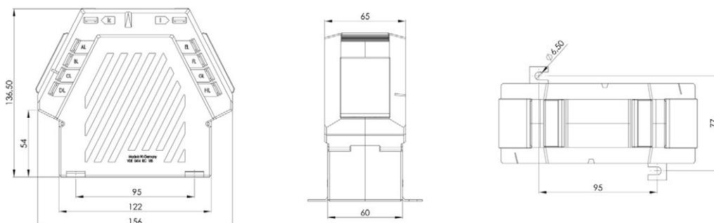
Summen-Stromwandler für Primär-Nennströme mit 5 A oder 1 A und einem Sekundär-Nennstrom von 5 A oder 1 A (optional 2 A) für den Anschluss von 4 Hauptwandlern, in den Genauigkeitsklassen 0,5 und 1 (optional in Klasse 0,2).
