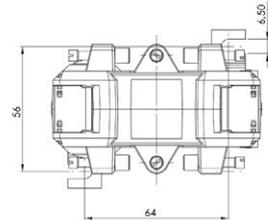
Stromwandler mit teilbarem Messkern für Primär-Nennströme von 100 A bis 400 A mit einem Sekundär-Nennstrom von 5 A oder 1 A (optional 2 A), in den Genauigkeitsklassen 0,5, 1 und 3.
