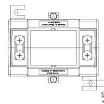
Aufsteck-Stromwandler für Primär-Nennströme von 100 A bis 1500 A mit einem Sekundär-Nennstrom von 5 A oder 1 A (optional 2 A), in den Genauigkeitsklassen 0,5 und 1 (optional in Klasse 0,2 und 0,5s).
