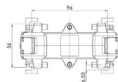
Stromwandler mit teilbarem Messkern für Primär-Nennströme von 250 A bis 1000 A mit einem Sekundär-Nennstrom von 5 A oder 1 A (optional 2 A), in den Genauigkeitsklassen 0,5 und 1.
