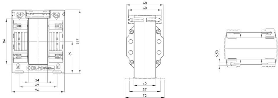
Aufsteck-Stromwandler für Primär-Nennströme von 300 A bis 2000 A mit einem Sekundär-Nennstrom von 5 A oder 1 A (optional 2 A), in den Genauigkeitsklassen 0,5 und 1. Bei Bestellung wahlweise wählbare Sekundärklemmenpositionen ermöglichen flexible Einbaulagen.
