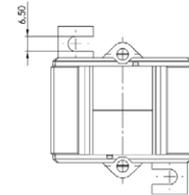
Aufsteck-Stromwandler für Primär-Nennströme von 50 A bis 750 A mit einem Sekundär-Nennstrom von 5 A oder 1 A (optional 2 A), in den Genauigkeitsklassen 0,2s, 0,5 und 1 (optional in Klasse 0,2 und 0,5s).
