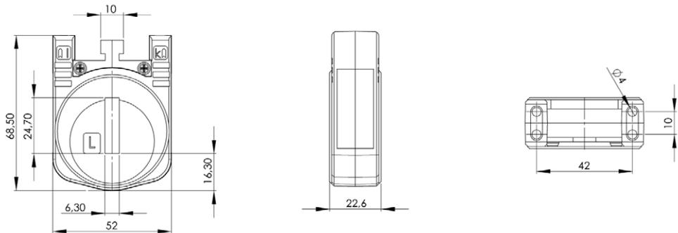
Stromwandler für Sicherungstrennleisten für Primär-Nennströme von 100 A bis 400 A mit einem Sekundär-Nennstrom von 5 A oder 1 A, in der Genauigkeitsklasse 3.
