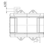
Aufsteck-Stromwandler für Primär-Nennströme von 300 A bis 1500 A mit einem Sekundär-Nennstrom von 5 A oder 1 A (optional 2 A), in den Genauigkeitsklassen 0,5 und 1.
