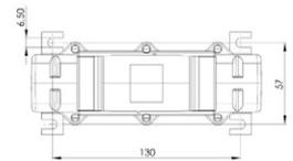
Aufsteck-Stromwandler für Primär-Nennströme von 1000 A bis 2500 A mit einem Sekundär-Nennstrom von 5 A oder 1 A (optional 2 A), in den Genauigkeitsklassen 0,5 und 1.
