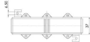
Dreiphasen-Stromwandlersatz für Primär-Nennströme von 3 x 100 A bis 3 x 600 A mit einem Sekundär-Nennstrom von 5 A oder 1 A, in der Genauigkeitsklasse 1.
