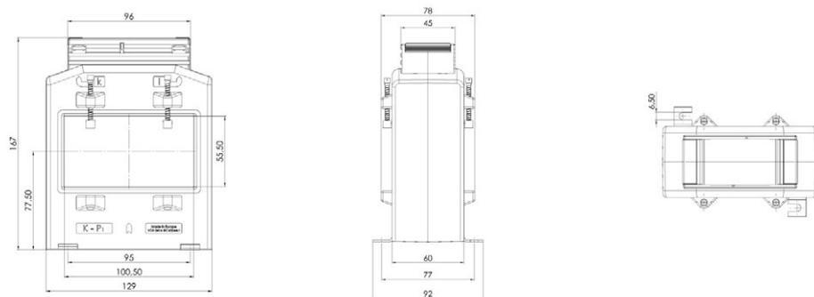
Aufsteck-Stromwandler für Primär-Nennströme von 600 A bis 3000 A mit einem Sekundär-Nennstrom von 5 A oder 1 A (optional 2 A), in den Genauigkeitsklassen 0,2s, 0,5 und 1 (optional in Klasse 0,2 und 0,5s).
