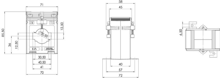
Aufsteck-Stromwandler für Primär-Nennströme von 50 A bis 800 A mit einem Sekundär-Nennstrom von 5 A oder 1 A (optional 2 A), in den Genauigkeitsklassen 0,5 und 1.
