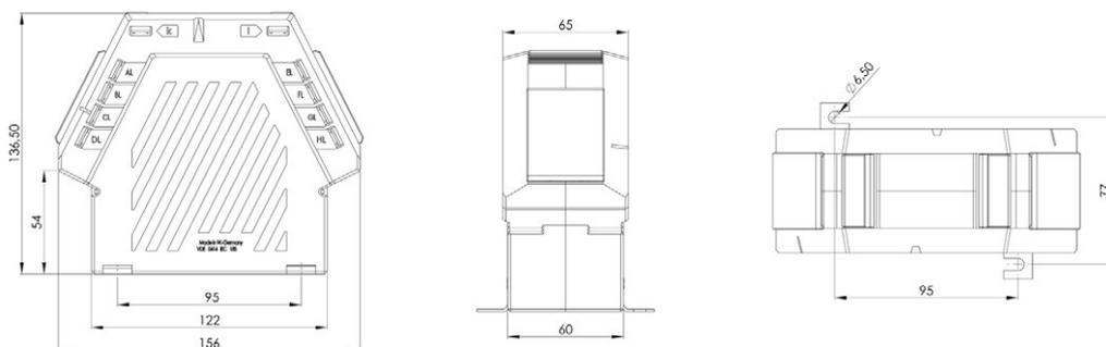
Summen-Stromwandler für Primär-Nennströme mit 5 A oder 1 A und einem Sekundär-Nennstrom von 5 A oder 1 A (optional 2 A) für den Anschluss von 3 Hauptwandlern, in den Genauigkeitsklassen 0,5 und 1 (optional in Klasse 0,2).
