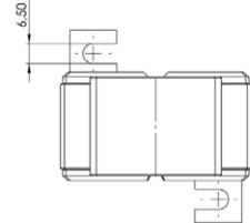
Wickel-Stromwandler für Primär-Nennströme von 1 A bis 20 A mit einem Sekundär-Nennstrom von 5 A oder 1 A (optional 2 A), in den Genauigkeitsklassen 0,5 und 1.
