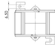
Sekundärseitig umschaltbare Aufsteck-Stromwandler für Primär-Nennströme von 200-100 A bis zu 1000-500 A mit einem Sekundär-Nennstrom von 5 A oder 1 A (optional 2 A), in der Genauigkeitsklasse 1 (optional in Klasse 0,5s und 0,5).
