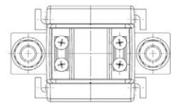
Wickel-Stromwandler für Primär-Nennströme von 25 A bis 150 A mit einem Sekundär-Nennstrom von 5 A oder 1 A (optional 2 A), in den Genauigkeitsklassen 0,5 und 1 (optional in Klasse 0,2 oder 0,5s).
