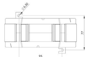
Summen-Stromwandler für Primär-Nennströme mit 5 A oder 1 A und einem Sekundär-Nennstrom von 5 A oder 1 A (optional 2 A) für den Anschluss von 6 Hauptwandlern, in den Genauigkeitsklassen 0,5 und 1 (optional in Klasse 0,2).
