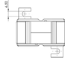
Sekundärseitig umschaltbare Rohrstab-Stromwandler für Primär-Nennströme von 200-100 A bis zu 600-300 A mit einem Sekundär-Nennstrom 5 A oder 1 A (optional 2 A), in der Genauigkeitsklasse 1.
