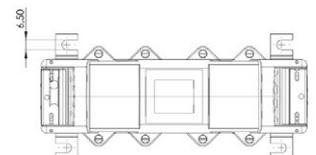
Aufsteck-Stromwandler für Primär-Nennströme von 300 A bis 3200 A mit einem Sekundär-Nennstrom von 5 A oder 1 A (optional 2 A), in den Genauigkeitsklassen 0,2s, 0,5 und 1 (optional in Klasse 0,2 und 0,5s).
