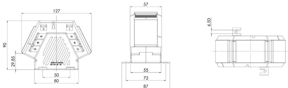
Summen-Stromwandler für Primär-Nennströme mit 5 A oder 1 A und einem Sekundär-Nennstrom von 5 A oder 1 A (optional 2 A) für den Anschluss von 3 Hauptwandlern, in den Genauigkeitsklassen 0,5 und 1.
