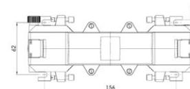
Stromwandler mit teilbarem Messkern für Primär-Nennströme von 1000 A bis 5000 A mit einem Sekundär-Nennstrom von 5 A oder 1 A (optional 2 A), in den Genauigkeitsklassen 0,5 und 1.
