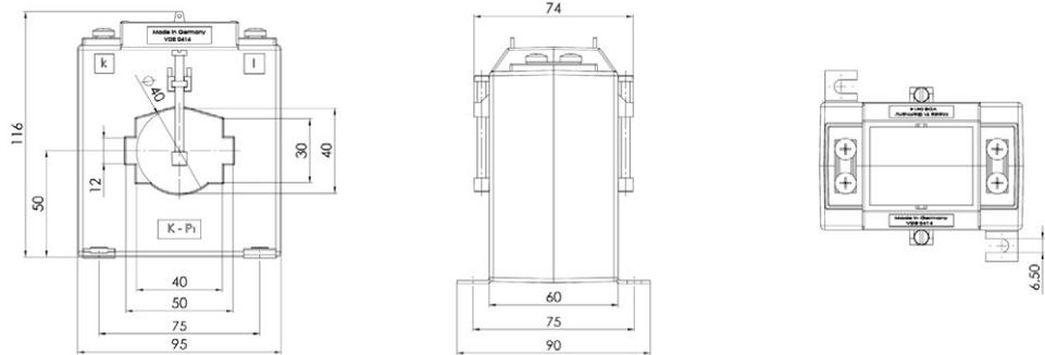
Schutz-Aufsteck-Stromwandler für Primär-Nennströme von 150 A bis 1000 A mit einem Sekundär-Nennstrom von 5 A oder 1 A (optional 2 A), in den Schutzklassen 5P5, 10P5, 5P10 und 10P10.
