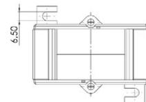
Sekundärseitig umschaltbare Aufsteck-Stromwandler für Primär-Nennströme von 600-400-200 A bis zu 1200-1000-300 A mit einem Sekundär-Nennstrom von 5 A oder 1 A (optional 2 A), in der Genauigkeitsklasse 1.
