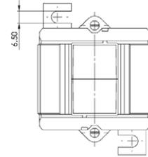
Schutz-Aufsteck-Stromwandler für Primär-Nennströme von 75 A bis 750 A mit einem Sekundär-Nennstrom von 5 A oder 1 A (optional 2 A), in den Schutzklassen 5P5 und 10P5
