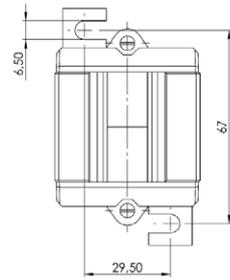
Aufsteck-Stromwandler für Primär-Nennströme von 60 A bis 500 A mit einem Sekundär-Nennstrom von 5 A oder 1 A (optional 2 A), in den Genauigkeitsklassen 0,5 und 1.
