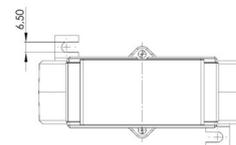
Sekundärseitig umschaltbare Aufsteck-Stromwandler für Primär-Nennströme von 1200-600 A bis zu 2000-1000 A mit einem Sekundär-Nennstrom von 5 A oder 1 A (optional 2 A), in der Genauigkeitsklasse 1.
