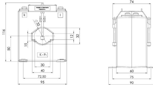
Schutz-Aufsteck-Stromwandler für Primär-Nennströme von 75 A bis 750 A mit einem Sekundär-Nennstrom von 5 A oder 1 A (optional 2 A), in den Schutzklassen 5P5, 10P5, 5P10 und 10P10.
