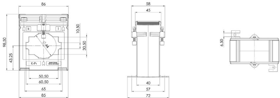
Aufsteck-Stromwandler für Primär-Nennströme von 200 A bis 1250 A mit einem Sekundär-Nennstrom von 5 A oder 1 A (optional 2 A), in den Genauigkeitsklassen 0,5 und 1.
