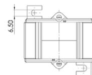
Sekundärseitig umschaltbare Aufsteck-Stromwandler für Primär-Nennströme von 400-200-100 A bis zu 1000-500-250 A mit einem Sekundär-Nennstrom von 5 A oder 1 A (optional 2 A), in der Genauigkeitsklasse 1.
