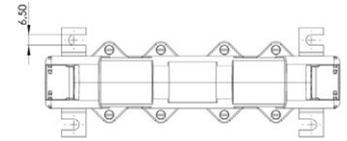
Aufsteck-Stromwandler für Primär-Nennströme von 300 A bis 1600 A mit einem Sekundär-Nennstrom von 5 A oder 1 A (optional 2 A), in den Genauigkeitsklassen 0,2s, 0,5 und 1 (optional in Klasse 0,2 und 0,5s).
