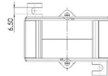
Sekundärseitig umschaltbare Aufsteck-Stromwandler für Primär-Nennströme von 400-200 A bis zu 1200-600 A mit einem Sekundär-Nennstrom von 5 A oder 1 A (optional 2 A), in der Genauigkeitsklasse 1 (optional in Klasse 0,5s und 0,5).
