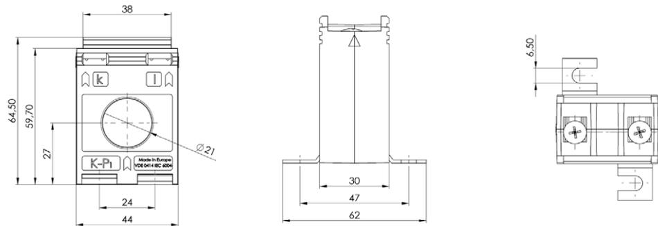
Rohrstab-Stromwandler für Primär-Nennströme von 60 A bis 300 A mit einem Sekundär-Nennstrom von 5 A oder 1 A (optional 2 A), in den Genauigkeitsklassen 3, 1 und 0,5.
