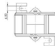
Aufsteck-Stromwandler für Primär-Nennströme von 50 A bis 750 A mit einem Sekundär-Nennstrom von 5 A oder 1 A (optional 2 A), in den Genauigkeitsklassen 0,2s, 0,5 und 1 (optional in Klasse 0,2 und 0,5s).
