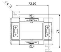
Aufsteck-Stromwandler für Primär-Nennströme von 40 A bis 750 A mit einem Sekundär-Nennstrom von 5 A oder 1 A (optional 2 A), in den Genauigkeitsklassen 0,5 und 1 (optional in Klasse 0,2 und 0,5s).
