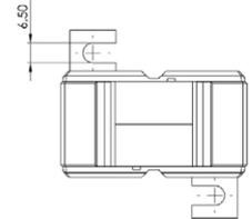
Schutz-Rohrstab-Stromwandler für Primär-Nennströme von 100 A bis 300 A mit einem Sekundär-Nennstrom von 5 A oder 1 A (optional 2 A), in den Schutzklassen 5P5 und 10P5.
