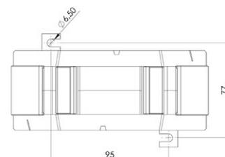
Summen-Stromwandler für Primär-Nennströme mit 5 A oder 1 A und einem Sekundär-Nennstrom von 5 A oder 1 A (optional 2 A) für den Anschluss von 4 Hauptwandlern, in den Genauigkeitsklassen 0,5 und 1 (optional in Klasse 0,2).
