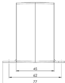
Rohrstab-Stromwandler für Primär-Nennströme von 150 A bis 800 A mit einem Sekundär-Nennstrom von 5 A oder 1 A (optional 2 A), in der Genauigkeitsklasse 1 mit flexiblen 2,5 mm<sup>2</sup> Cu-Litzeleitungen (Sekundäranschlussleitungen).
