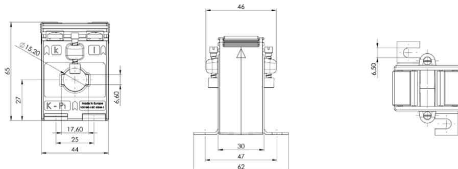
Aufsteck-Stromwandler für Primär-Nennströme von 75 A bis 250 A mit einem Sekundär-Nennstrom von 5 A oder 1 A (optional 2 A), in den Genauigkeitsklassen 3, 1 und 0,5.
