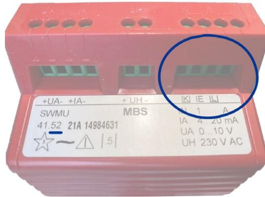
Bei den Modellen SWMU XX.52 ( $I \leq 10A$ ) wird der Primärleiter an den Klemmen angeschlossen und nicht durch den Wandler geführt.
